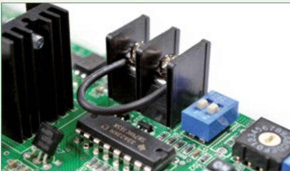
Alarmový kontakt/kontakt pro externí uvolnění Bezpotenciálový, pro sledování alarmů ze strany stavby nebo pro externí ovládání typu start/stop
