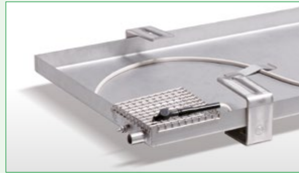
Vana pro zachycení kondenzátu včetně odlučovače oleje z ušlechtilé oceli pro vnější jednotku s teplotně regulovaným topením odtoku kondenzátoru, s mřížkou pro zachycení listí a s odlučovačem oleje.
